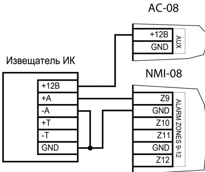
Рисунок 4. Подключение охранного датчика без контроля состояния линии
