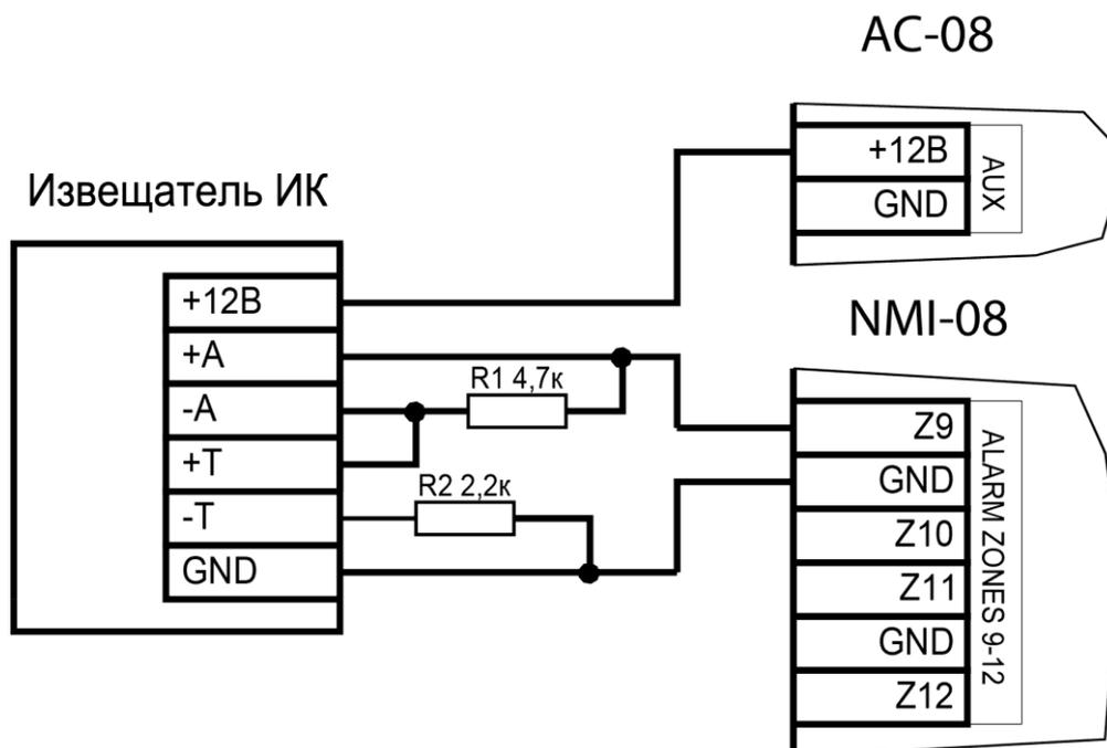
Рисунок 3. Подключение охранного датчика с контролем состояния линии
