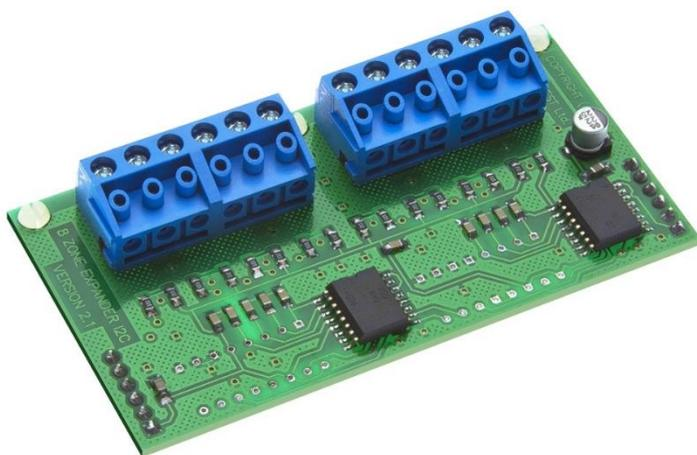
Рисунок 1. Зонный расширитель
