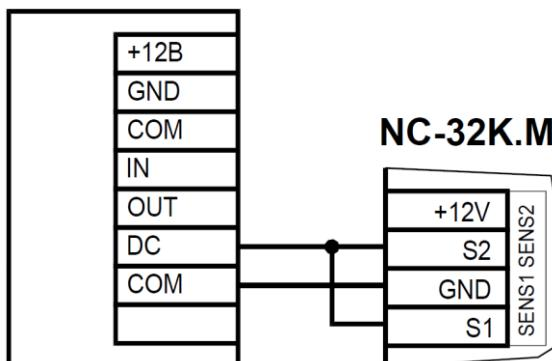
Рисунок 14. Схема подключения турникета с одним датчиком проворота
