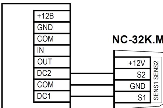
Рисунок 15. Схема подключения турникета с двумя датчиками проворота
