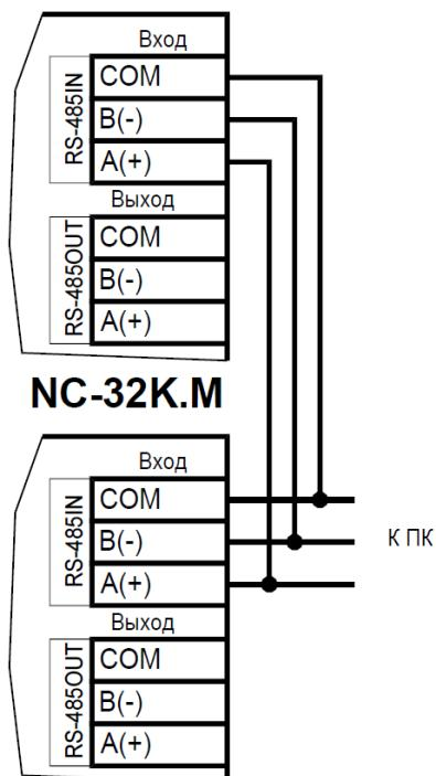
Рисунок 29. Соединение контроллеров по топологии «Звезда»
