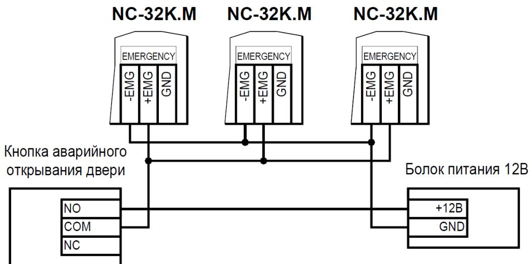
Рисунок 25. Подключение одной кнопки к нескольким контроллерам
