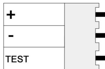
Рисунок 2. Назначение контактов разъема POWER
