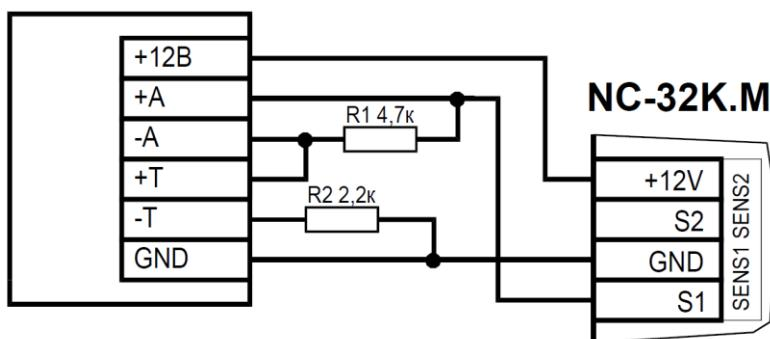
Рисунок 19. Схема подключения охранного датчика с контролем состояния линии
