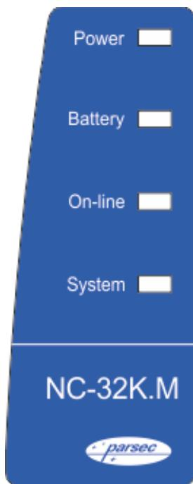
Контроллер снабжен отдельной платой индикации, которая расположена на дверце корпуса, что позволяет отслеживать состояния контроллера, не открывая его. Плата индикации подключена к плате контроллера при помощи специального ленточного кабеля. Наклейка с внешней стороны дверцы (рисунок 26) информирует о типе контроллера и назначении светодиодов:
