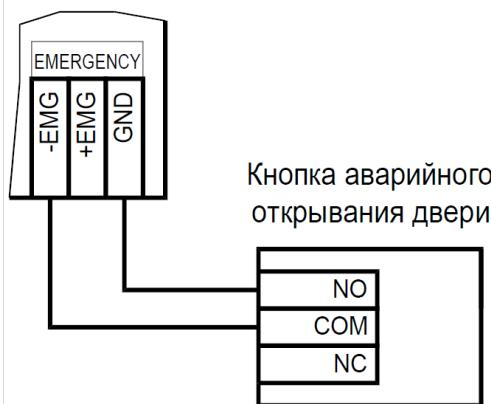
Рисунок 24. Подключение кнопки аварийного выхода к одному контроллеру
