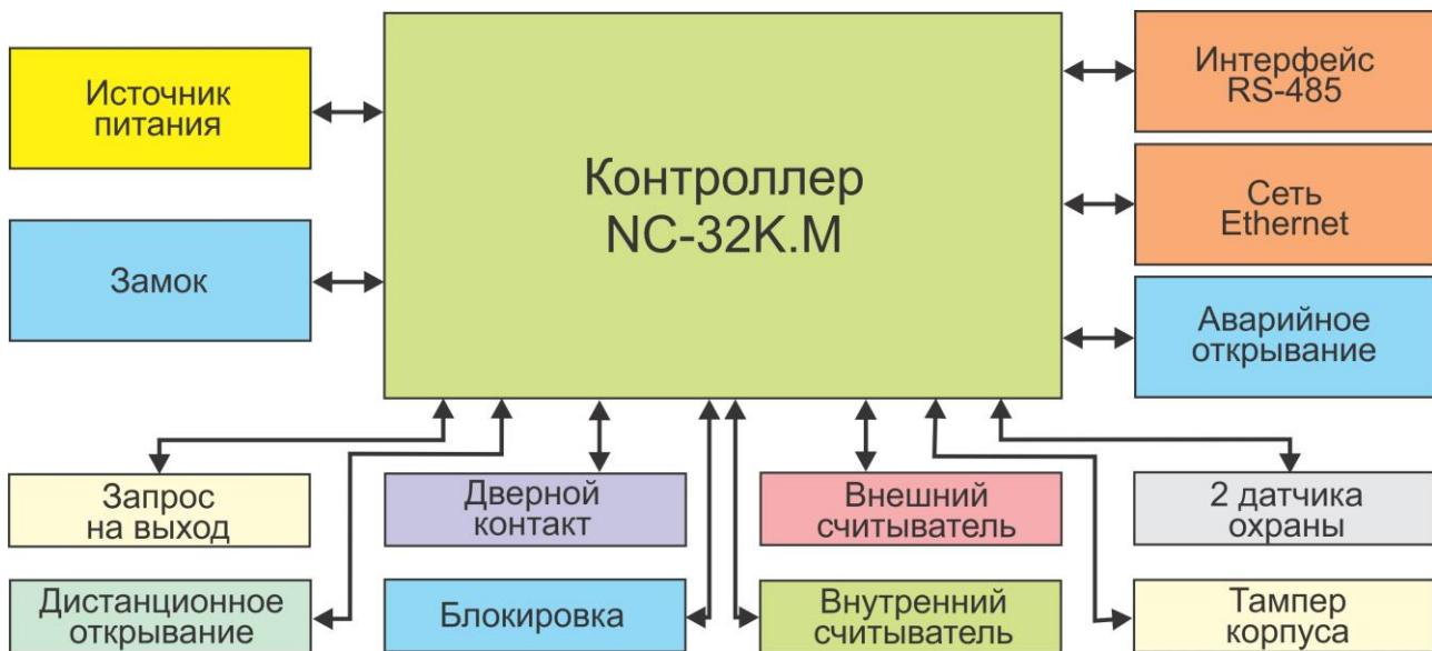
Рисунок 6. Оборудование, подключаемое к контроллеру NC-32K.M
