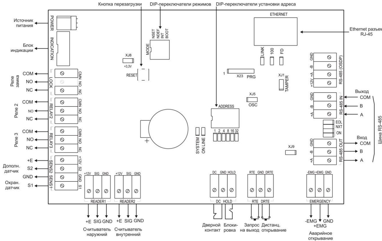
Рисунок 1. Схема платы контроллера NC-32K.M
