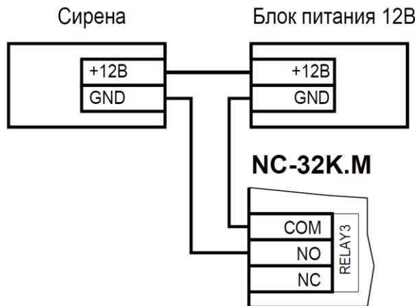
Рисунок 22. Схема подключения сирены к дополнительному реле
