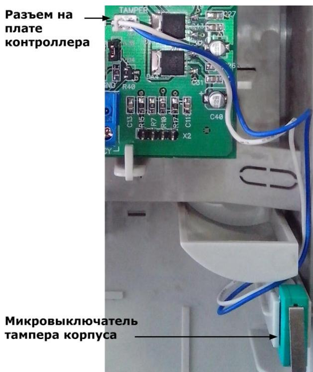
Рисунок 23. Подключение тампера корпуса
