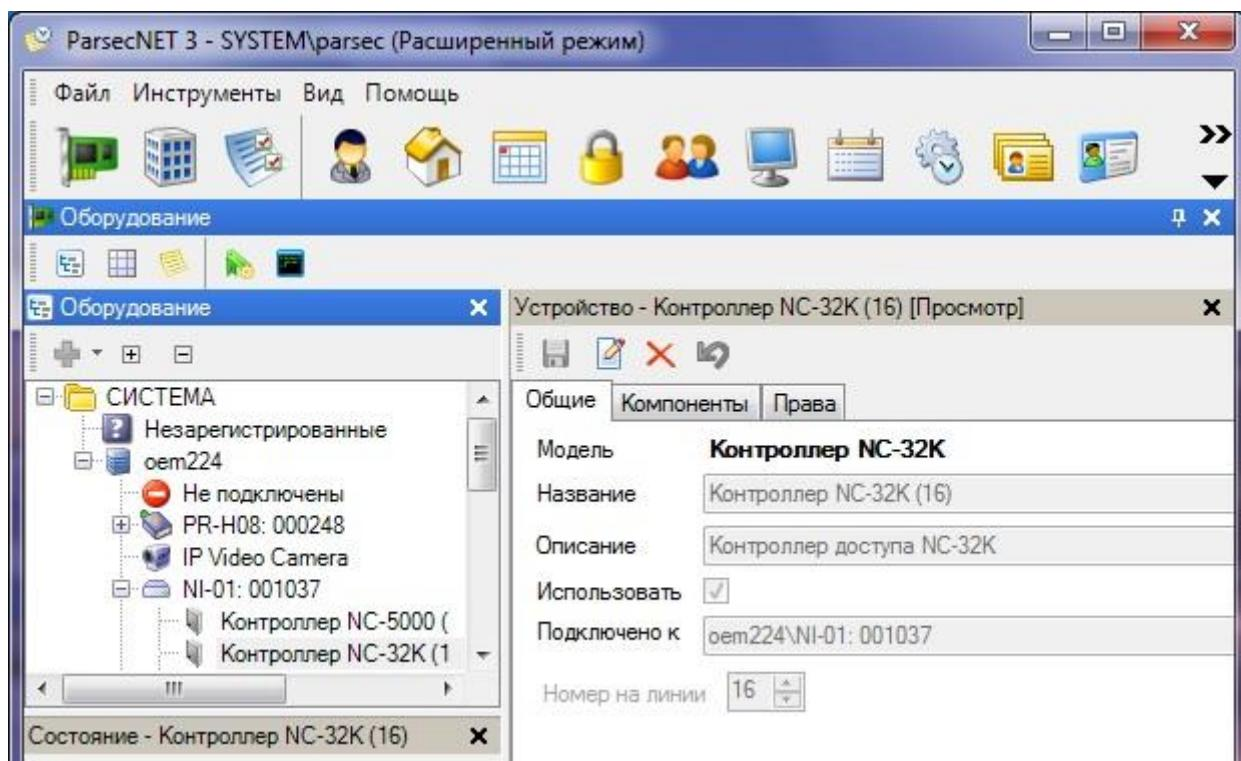
Рисунок 30. Контроллер в ParsecNET 3 при подключении по RS-485
