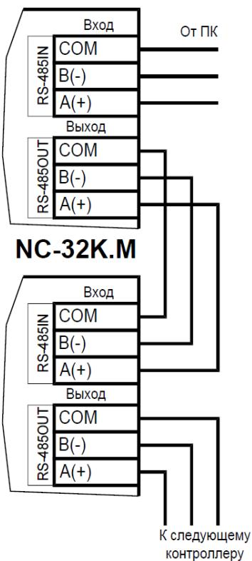
Рисунок 28. Соединение контроллеров по топологии «Шина»
