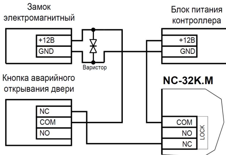
Рисунок 11. Подключение запираемого напряжением замка к контроллеру
