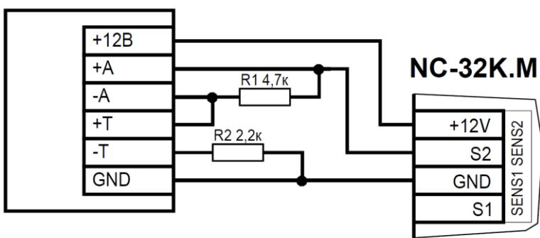
Рисунок 20. Схема подключения дополнительного датчика с контролем состояния линии
